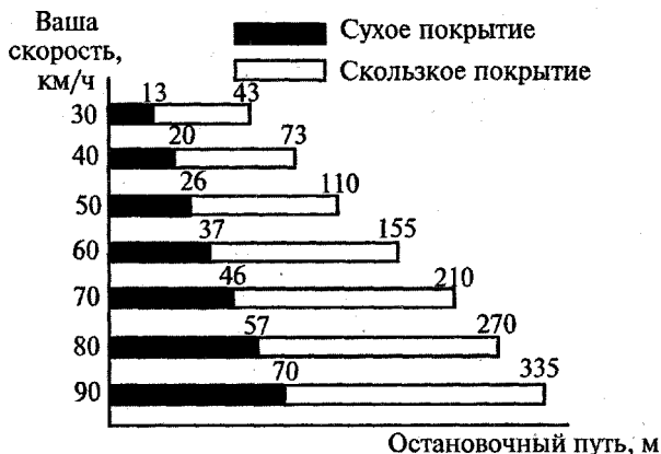
Рис. 43. Зависимость остановочного пути от скорости движения и покрытия дороги
